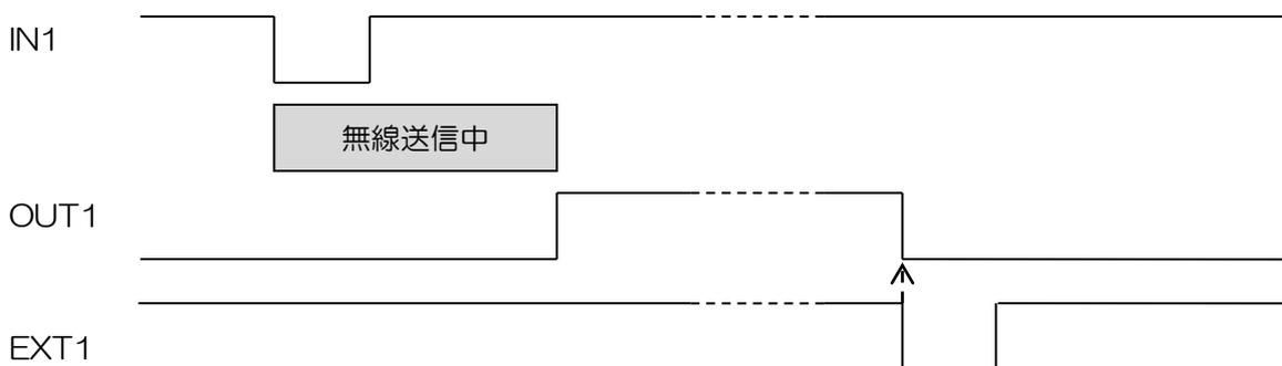
オルタネイト動作（1-8 トグル）の場合には、送信機と同じ入力端子（IN1～8）で受信機出力端子（OUT1～8）のアクティブ／インアクティブが切り替わります。オルタネイト動作（2-4 トグル）の場合には、送信機の違う入力端子（IN1～8）で受信機出力端子（OUT1～8）のアクティブ・インアクティブを切り替えます。1 2、3 4、5 6、7 8の組みになっているので、入力端子 IN1 をグランドに落とすと、出力端子 OUT1 がアクティブになり、OUT2 がインアクティブになります。入力端子 IN2 をグランドに落とすと、出力端子 OUT1 がインアクティブになり、OUT2 がアクティブになります。
