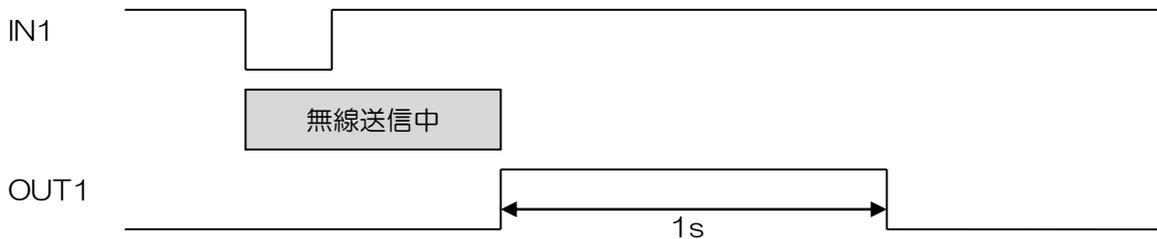
図4 受信機のモーメンタリ動作（拡張入力端子使用、アクティブハイの場合）
