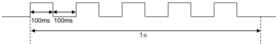
リンク状態では、受信機が見つかるまで一定間隔で送信を繰り返します。受信機から返信を受けると、スタンバイ状態に移行します。
